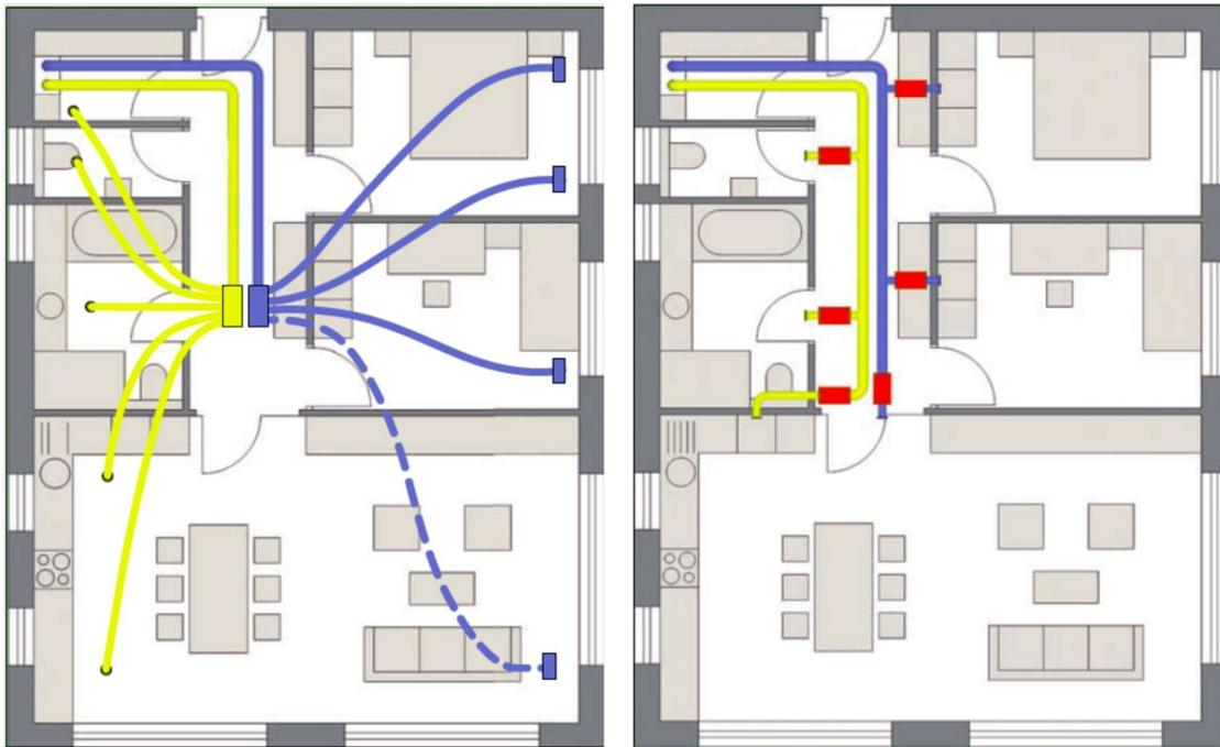
Abbildung 28: Schematische Darstellung einer Sternverrohrung (links) und einer Verrohrung mit Abzweigern (Gremel, 2013)
