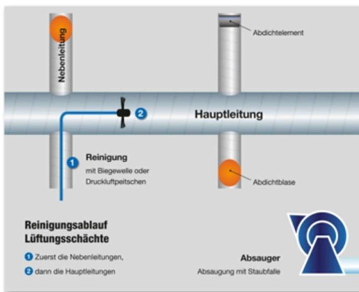
Abbildung 19: Prinzipschema einer Bürstenreinigung, Quelle: breg-rauchfangkehrer.at
