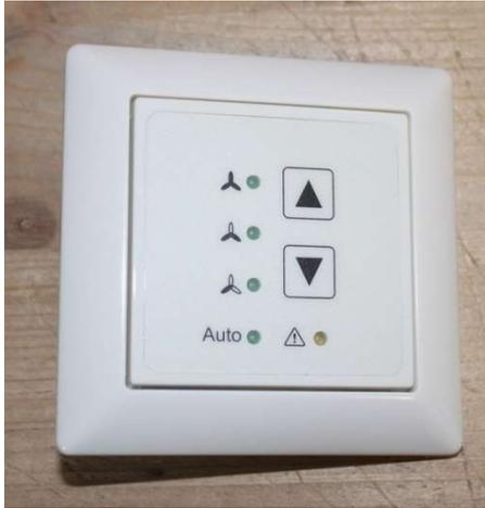
Abbildung 17: Bedienelement Funktionen: Ein/Aus, 3 Ventilatorstufen, Automatik. LED-Anzeige: Betriebsmodus, Filtermeldung, Störmeldung.
