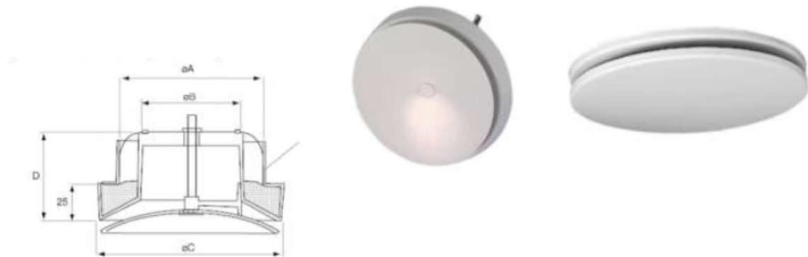
Abb. 3-50: Zuluftventile (Quelle Systemair)
